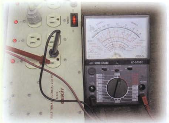
Figura 3.11. Medida de voltaje en CA
